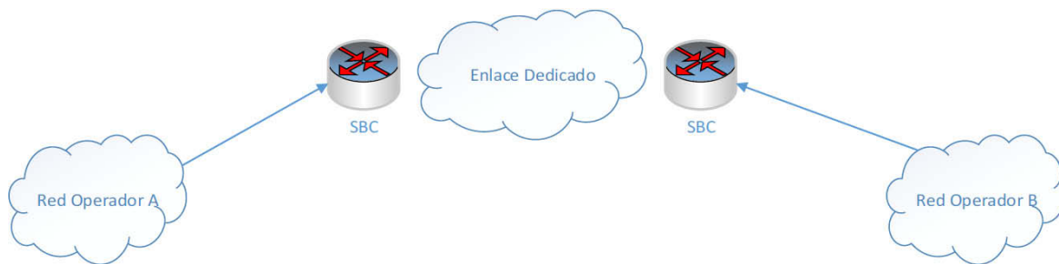
Figura 1: Topología de interconexión SBC-SBC
